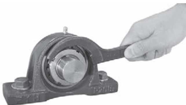
図 14.7 ロックナットの締め付け
