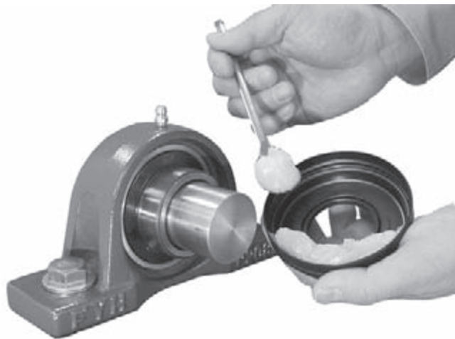
図 14.12 カバーのシールリップと内部空間にグリースを詰める
