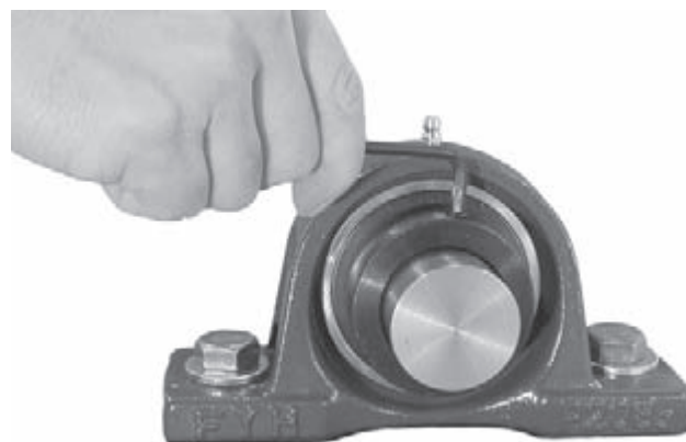
図 14.10 偏心固定輪の取付け
