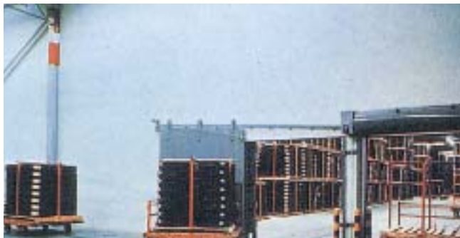
タイヤ搬送用トウラインコンベヤシステム
